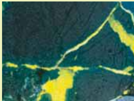
Microscopie à fluorescence sur coupes minces de carottes de granit pour l'analyse des propriétés de fissuration de la roche cristalline.
