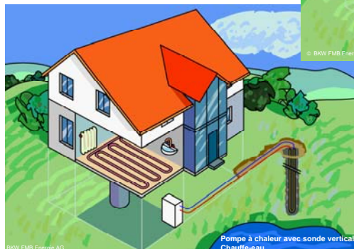
Pompe à chaleur avec sonde verticale Chauffe-eau
