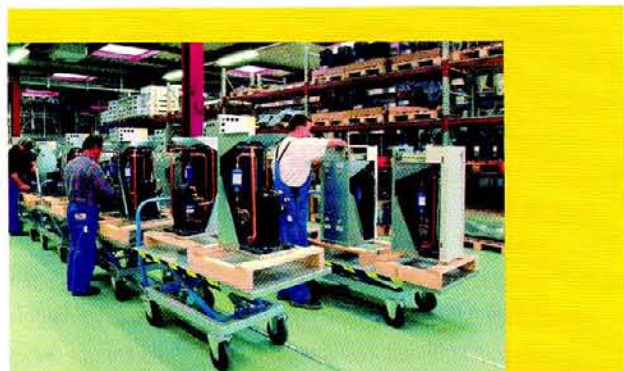
Fig. 1 : PAC «simples» à la sortie de la chaîne de montage. L'installateur choisit un modèle qui convient à la maison à chauffer.
